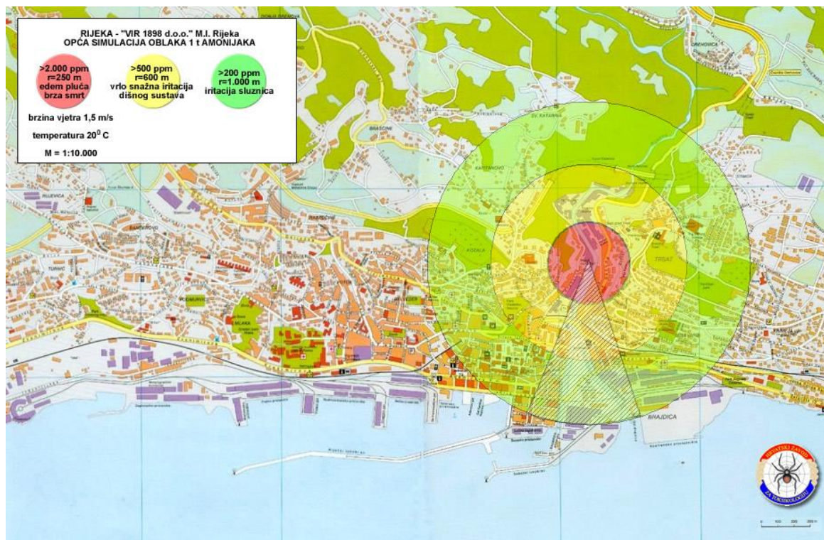
Slika 5.11.6. Prikaz zona različitih koncentracija amonijaka kod brzog istjecanja 1 tona kemikalije u tvrtki Vir iz Rijeke
